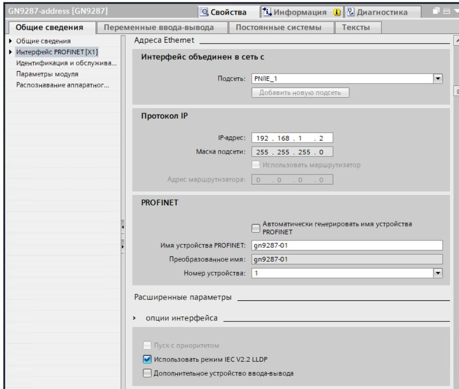
Назначить IP-адрес можно в меню «Онлайн и диагностика» в соответствующей вкладке.
