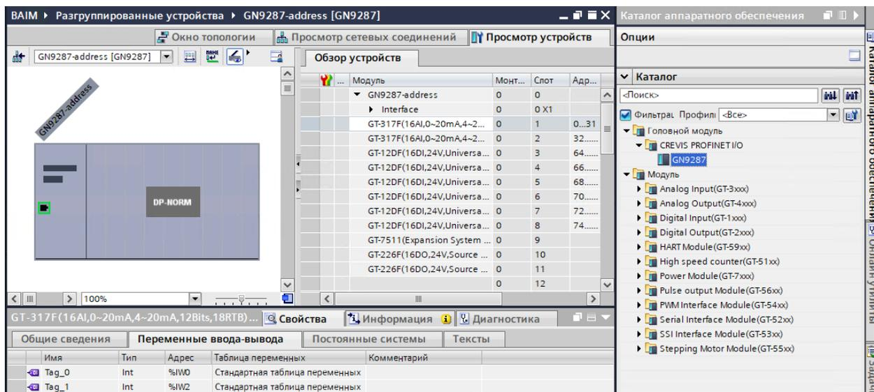
Сетевые настройки устройства задаются в меню «Общие сведения» соответствующего адаптера во вкладке «Интерфейс PROFINET».
